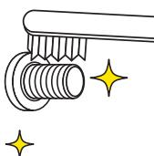
ディスクホイール取付面、ホイールナット当たり面、ハブ取付面(ISO方式では、ハブのはめ合い部も)、ホイールボルト、ナットの錆やゴミ、泥、追加塗装などを取り除きます。
