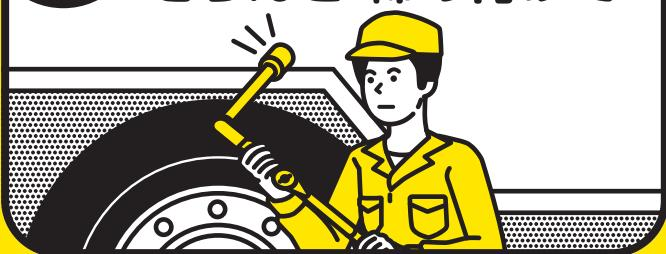
規定のトルクで確実な締め付けを
